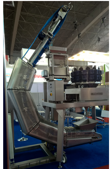
Liftvrac en C : champion toutes catégories de l'encombrement au sol (en haut avec une peseuse associative Multipond, ci-dessous en configuration d'alimentation d'un mélangeur placé à côté d'un hachoir)
